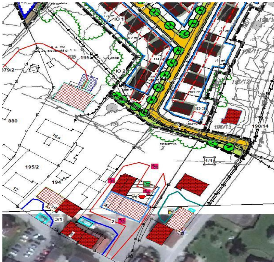
Abbildung 2.1: Lageplan mit Kennzeichnung Immissionsorte IO
